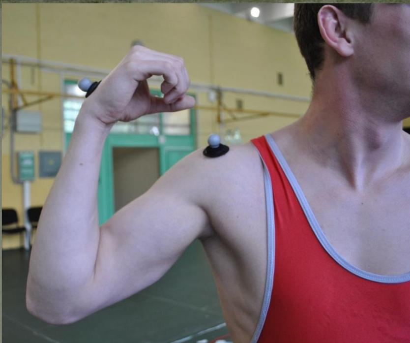
*Маркеры-отражатели закреплённые на теле испытуемого.*
