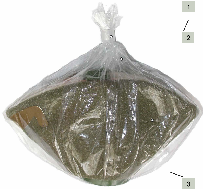
1 – кольцо; 2 – полиэтиленовый пакет; 3 - респиратор
