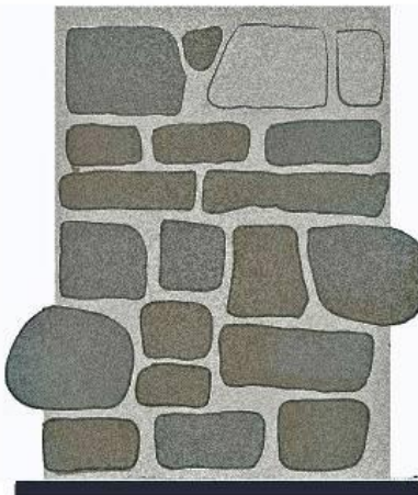
mur z kamienia łamanego z głazami polodowcowymi
