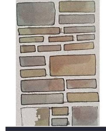
mur z ciosów z warstwami wyrównawczymi
