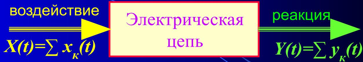
Если рассматривать напряжения и токи источников как *задающие воздействия*, а напряжения и токи в отдельных ветвях цепи как *реакцию (отклик)* на эти воздействия, то принцип наложения может быть сформулирован так: *реакция линейной электрической цепи на сумму воздействий равна сумме реакций от каждого воздействия в отдельности.*
