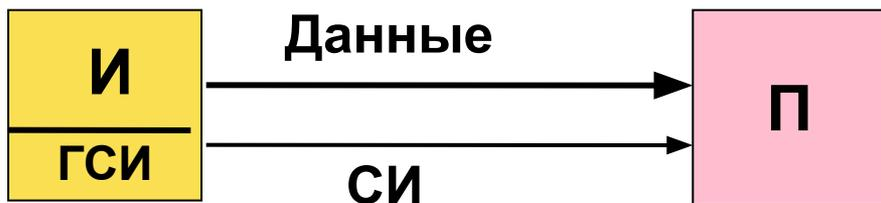
Использование двух ГСИ на источнике и приемнике, запускаемых одновременно при начале передачи данных
