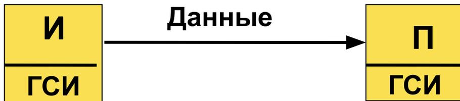
Использования принципа самосинхронизации. При этом сигналы 0 и 1 физически должны быть разными. Например 1 – изменение сигнала от низкого до высокого уровня, а 0 – наоборот.
