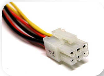
6-контактный разъём EPS
