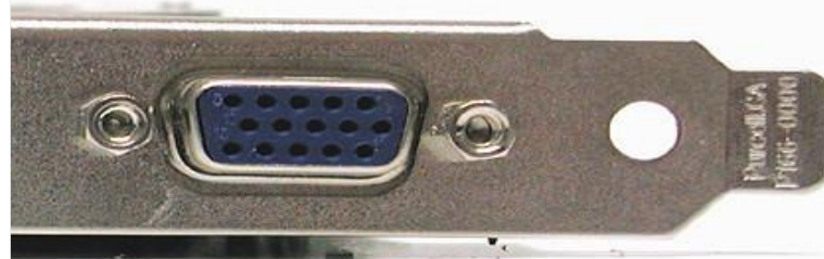
Порт VGA на графической карте
