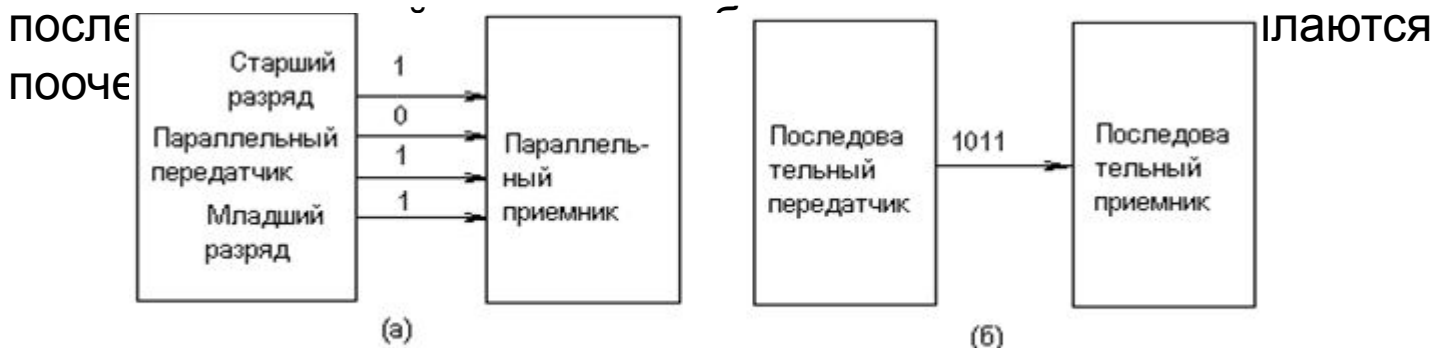
Рисунок 1 - Передача комбинации 1011_2 . (а) параллельная, (б) последовательная
