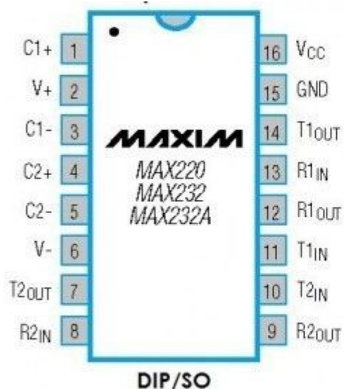
Рис.8 Конфигурация выводов MAX232
