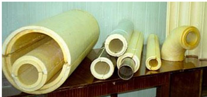
**Пенополиуретан - ППУ - жесткий пенополиуретан** - в настоящее время все чаще применяется в качестве **теплоизоляции**, позволяющей экономить до 25% тепла. Существует несколько способов такой изоляции:
