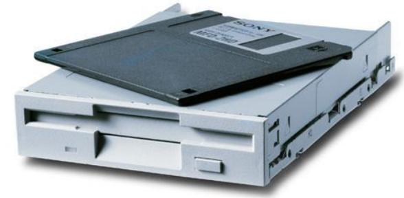
FDD бывают двух размеров: рассчитанные на дискеты 3,5" и 5,25". Способ записи на дискеты – намагничивание отдельных участков..
