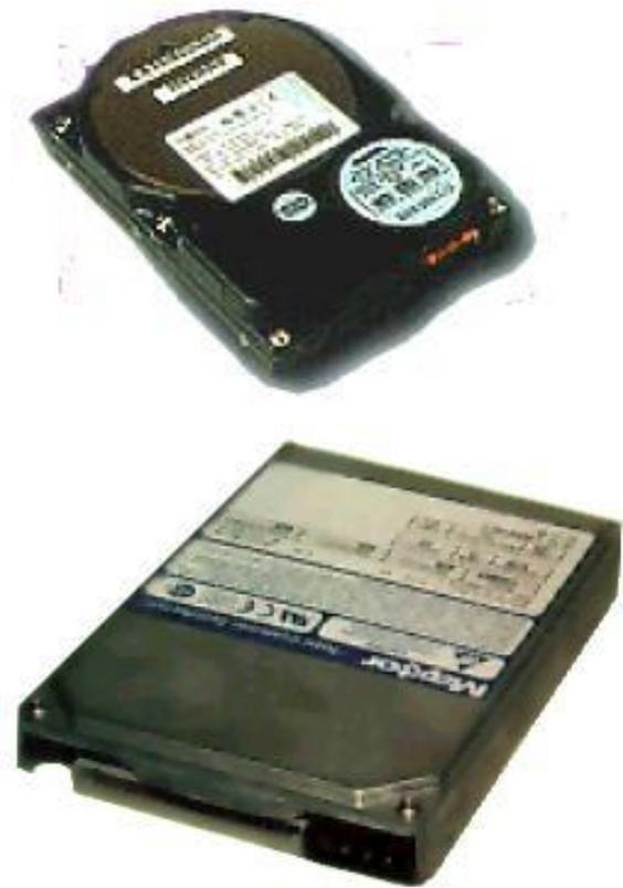
**Винчестер состоит из нескольких жестких (чаще алюминиевых) дисков, с нанесенным на поверхность магнитным слоем и расположенных друг под другом. Каждому диску соответствует пара головок записи/чтения. Скорость вращения дисков в зависимости от модели - до 15000 об./мин.**
