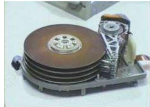
**Винчестеры или накопители на жестких дисках – это внешняя память большого объема, предназначенная для долговременного хранения информации, объединяющая в одном корпусе сам носитель информации и устройство записи/чтения. Объем хранимых данных достигает 1 Тбайт.**
