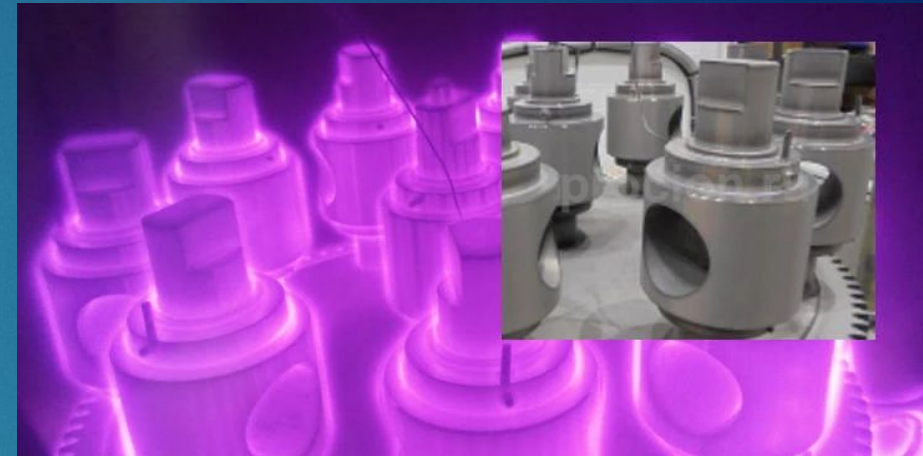
Ионное азотирование деталей запорной арматуры, сталь 38Х2МЮА / 1.8509 для ООО "Экомаш+Урал" (Россия, Екатеринбург)
