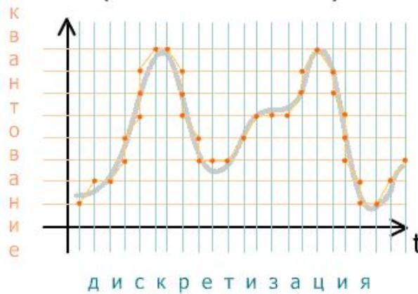
Кодирование сигнала в цифровой вид
