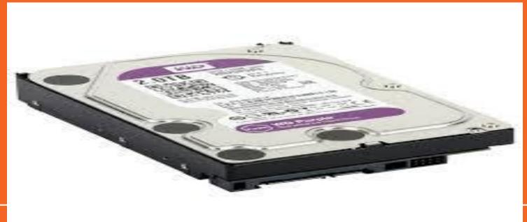
Плотность записи при этом методе резко возросла— более чем на 30 % ещё на первых образцах (на 2009 год— 400 Гбит/дюйм², или 62 Гбит/см²<sup>[8]</sup>). Теоретический предел отодвинулся на порядки и составляет более 1 Тбит/дюйм².
