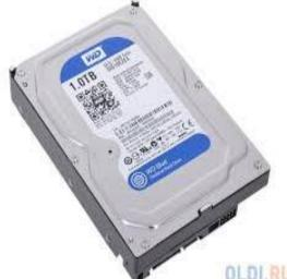
Биты информации записываются с помощью маленькой головки, которая, проходя над поверхностью вращающегося диска, намагничивает миллиарды горизонтальных дискретных областей — доменов. При этом вектор намагниченности домена расположен продольно, то есть параллельно поверхности диска. Каждая из этих областей является логическим нулём или единицей, в зависимости от направления намагниченности.
