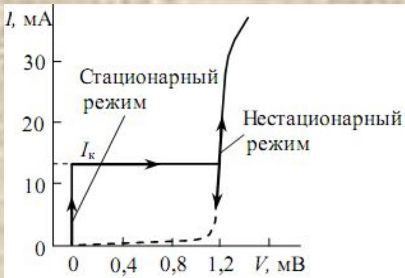
Рис. Вольтамперная характеристика туннельного контакта Sn-Sn при температуре 1,4 К. Прослойка - пленка оксида олова; стрелками показано направление изменения
