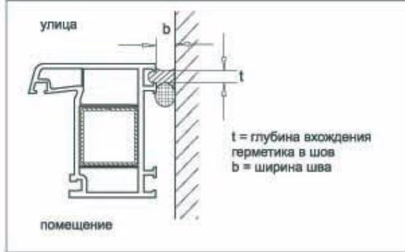
Рис. 30: Раздельные поверхности сцепления: герметик в пазе
