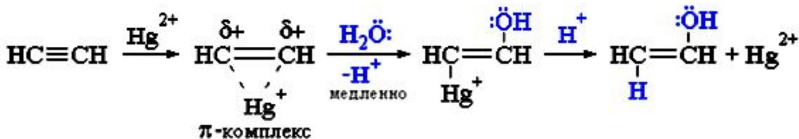
Катализатор  $\text{Hg}^{2+}$  активирует тройную связь, образуя электронодефицитный  $\pi$ -комплекс, который затем присоединяет нуклеофильный реагент  $\text{H}_2\text{O}$ : (донор пары электронов). Эта стадия протекает медленно и является лимитирующей. Именно по этой стадии реакция гидратации классифицируется как нуклеофильное присоединение.
