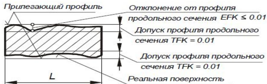
Пример нанесения допуска на чертеже по ГОСТ 2.308-79
