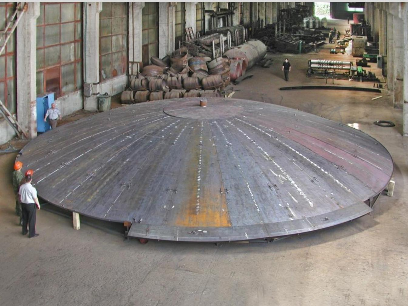
Рис. 8.22. Коническая щитовая кровля
