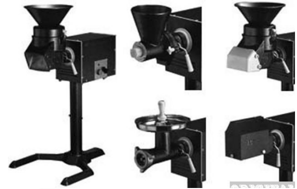
универсальный привод с комплект сменных механизмов
