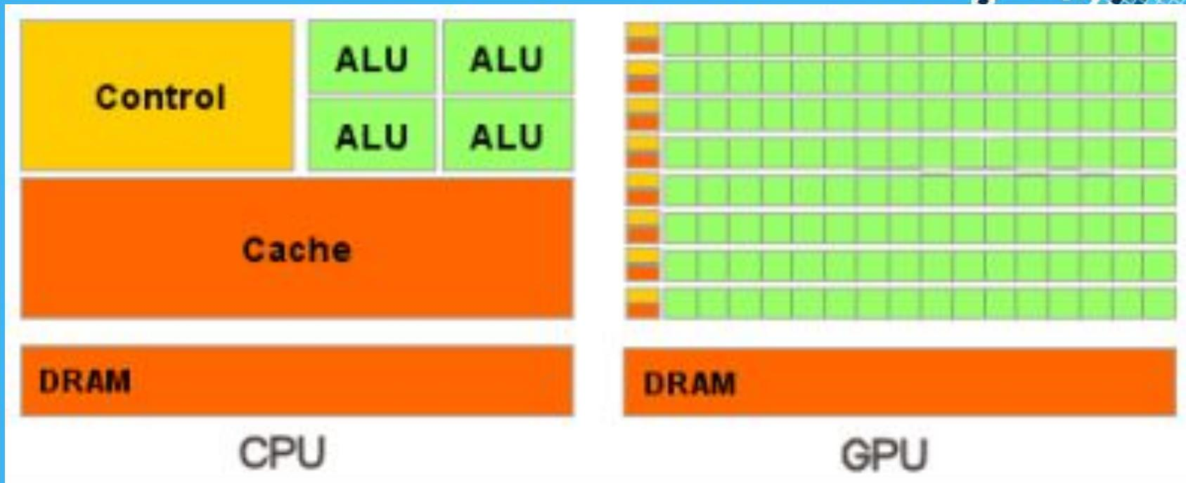
Параллельная обработка данных распределяет элементы данных на параллельно обрабатываемых потоках. GPU особенно хорошо подходит для решения проблем, которые могут быть выражены как вычислений данными параллельно - та же программа выполняется на многих элементов данных параллельно - с высокой интенсивностью - арифметическое отношение арифметических операций к операциям с памятью.
