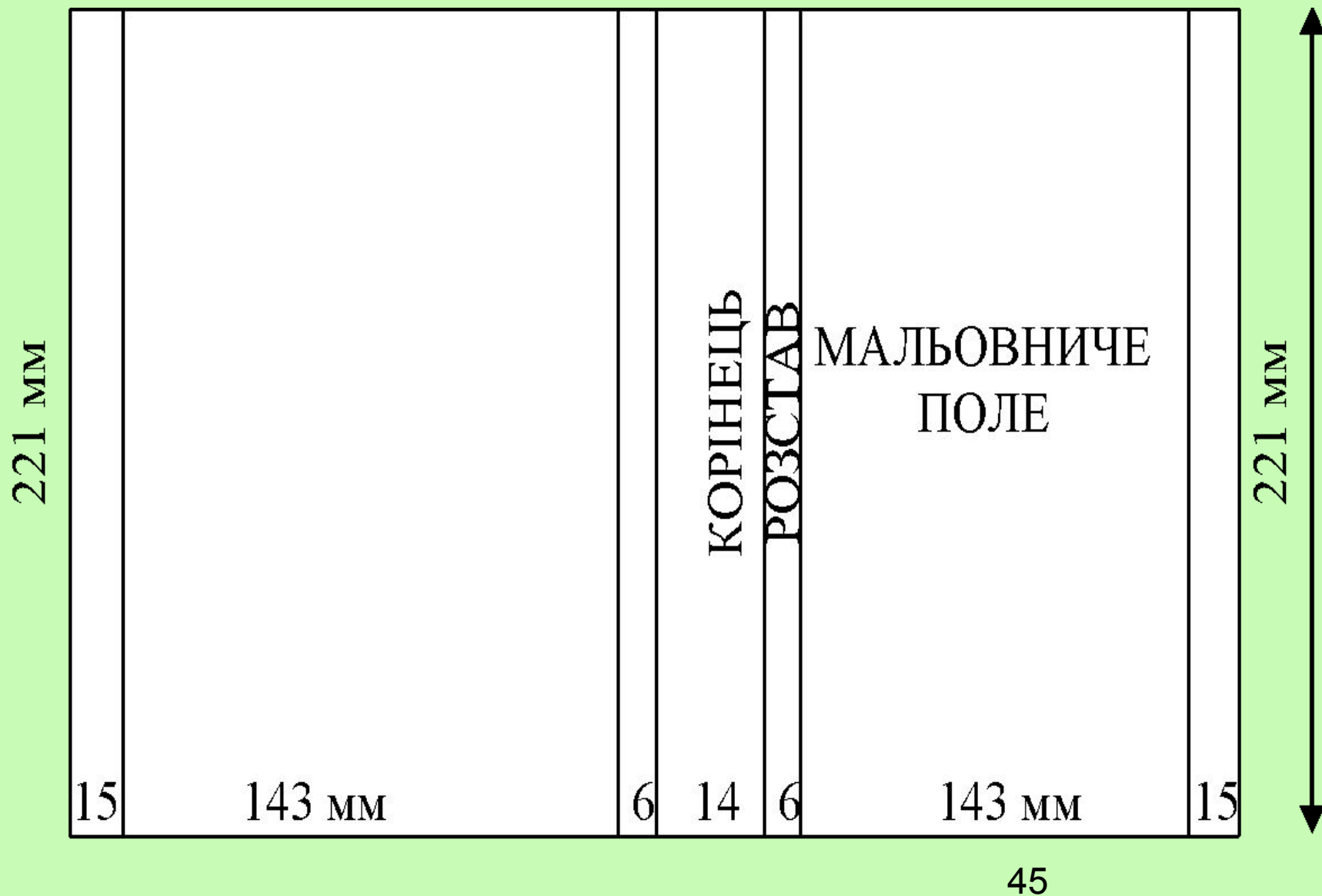
Рис. 10. Ескіз палітурки № 7 для видання форматом 60*90/16 обсягом 228 сторінок папері вагою 70 г/м 2 .
