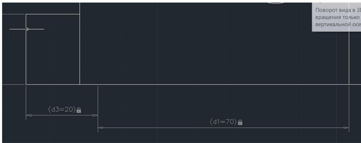
Чтобы получить ссылочный размер необходимо в свойствах размерной зависимости в поле *Вхождение* выбрать *Да*.
