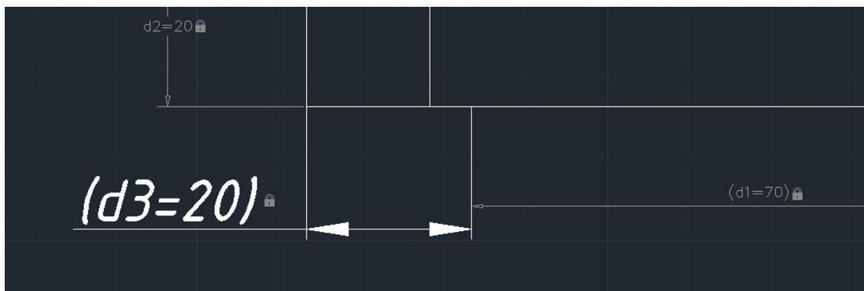
Управлять размерными и ссылочными размерами удобно с помощью Диспетчера параметров (команда `_PARAMETERS`)
