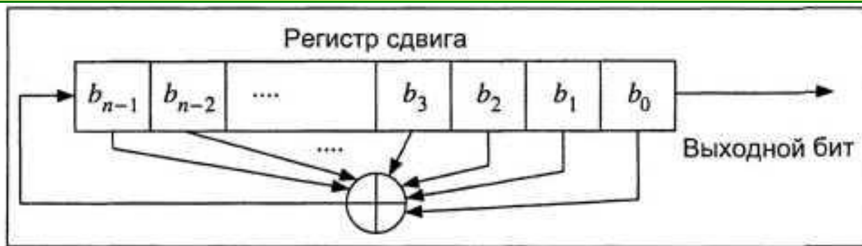
Рис. 16.2. Регистр сдвига с линейной обратной связью
