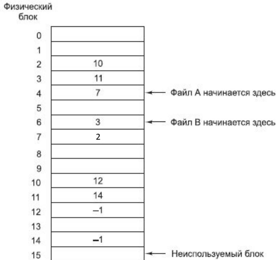
Рис. 4.9. Размещение с помощью связанного списка, использующего таблицу размещения файлов в оперативной памяти
