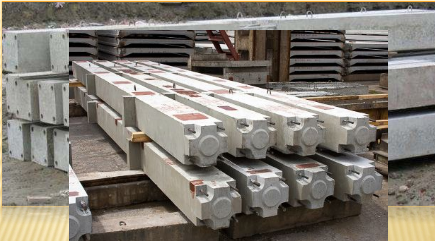
ХРАНЕНИЕ СБОРНЫХ ЖЕЛЕЗОБЕТОННЫХ КОЛОНН «ПЛАШНЯ»
