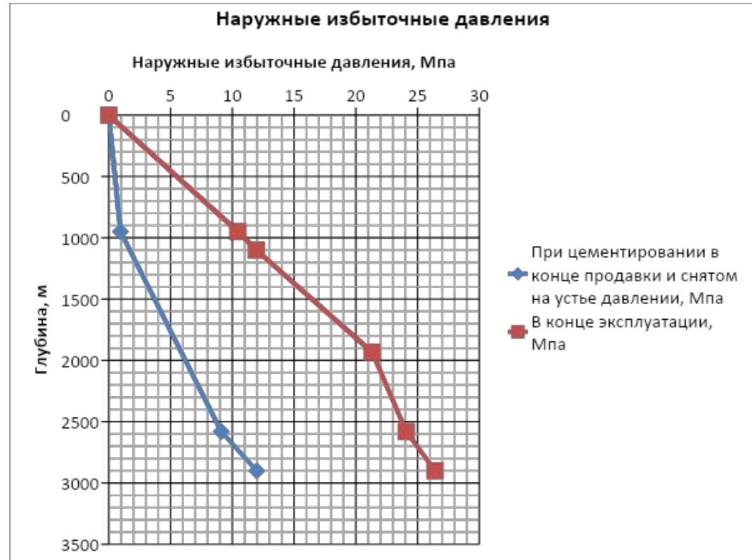
Эпюра наружных избыточных давлений
