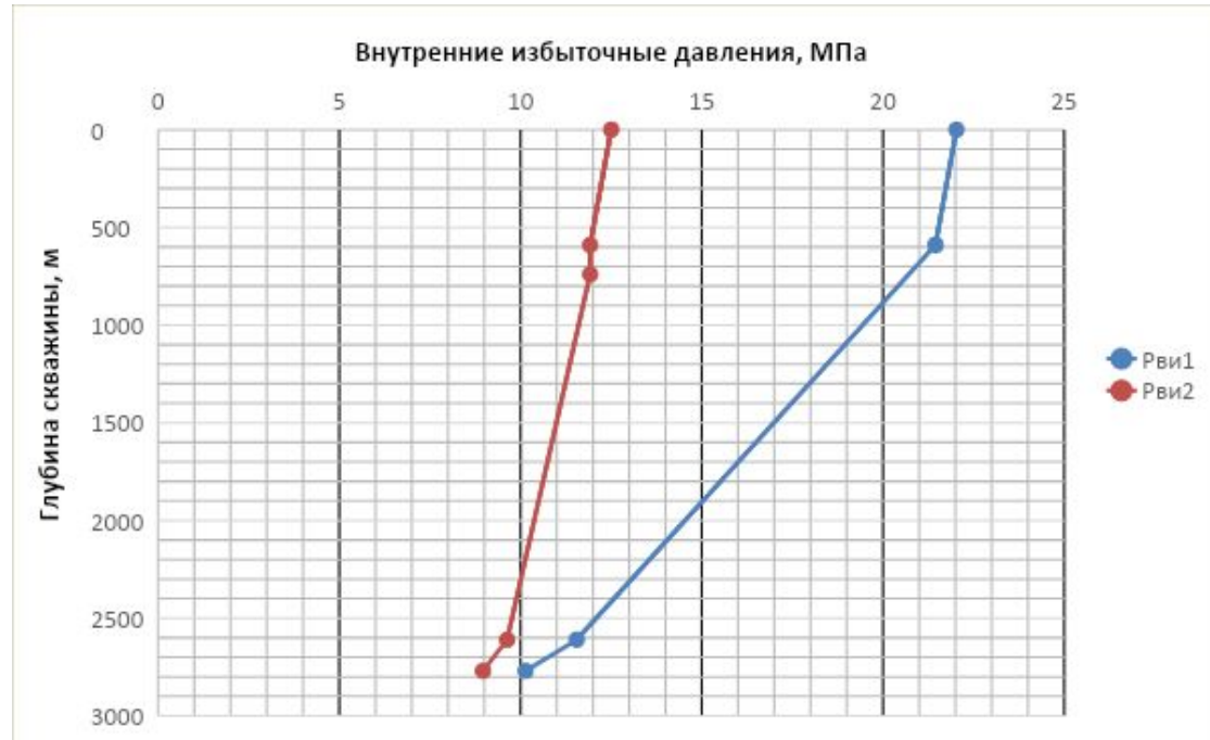
Эпюра внутренних избыточных давлений
