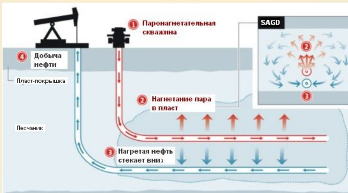
Технология добычи тяжелой нефти - SAGD (Steam Assisted Gravity Drainage)
