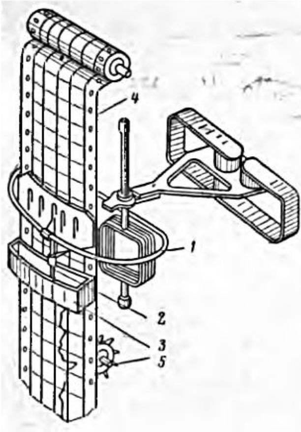
На кольце 1, заменяющем показывающую стрелку, укреплено капиллярное перо 2; в это перо поступают чернила из неподвижной чернильницы 3. Диаграммная бумага имеет отверстия, в которые входят штифты тянущего барабана 5, вращаемого синхронным электродвигателем.
