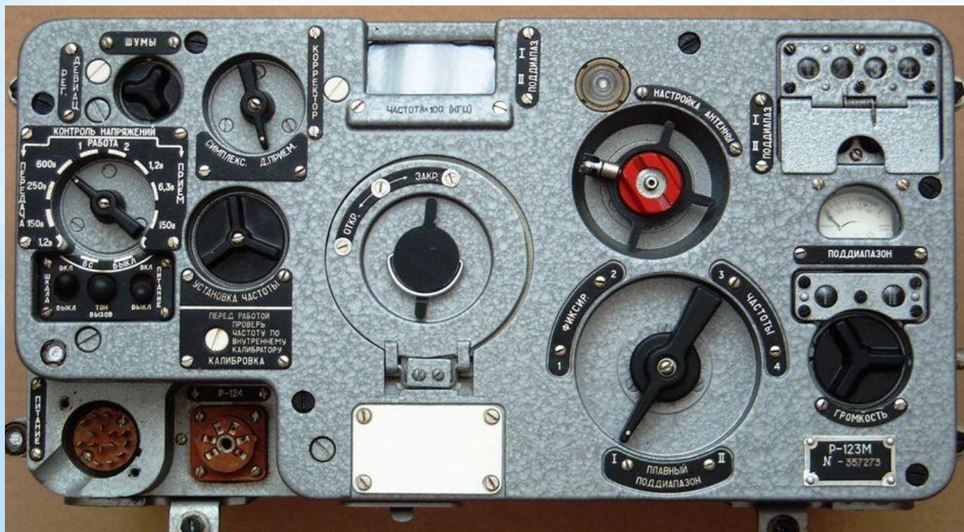
Мощность передатчика на любой частоте диапазона не менее 20 Вт.
