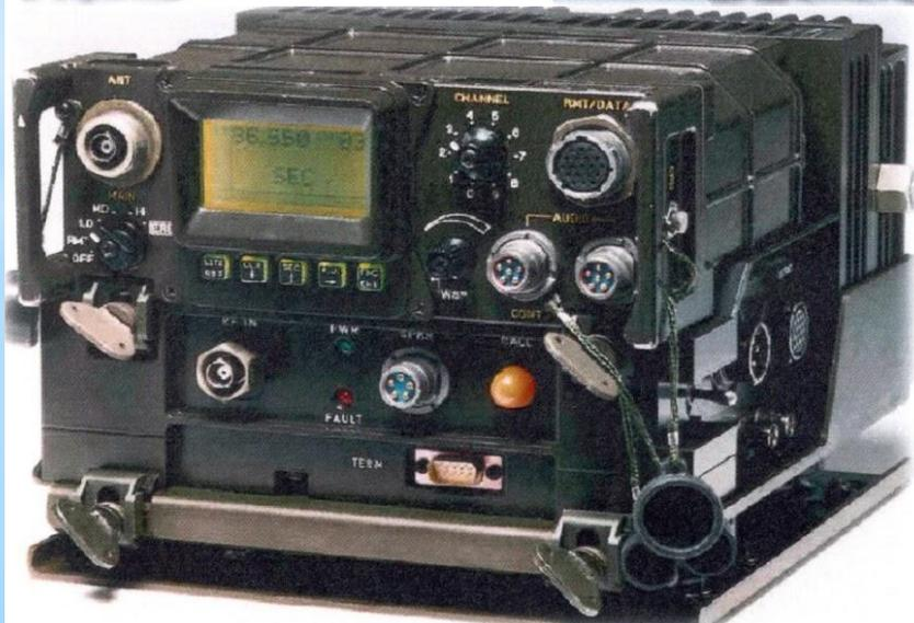
УКВ радиостанция 20 Вт «Тадиран» предназначен для организации связи в тактическом звене управления. Устанавливаются в подвижные объекты (БТР, танки, БМП и др.)
