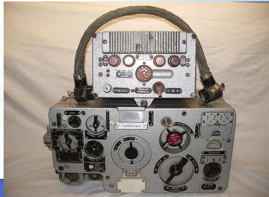
**Конструкция радиостанции Р-123М.**
