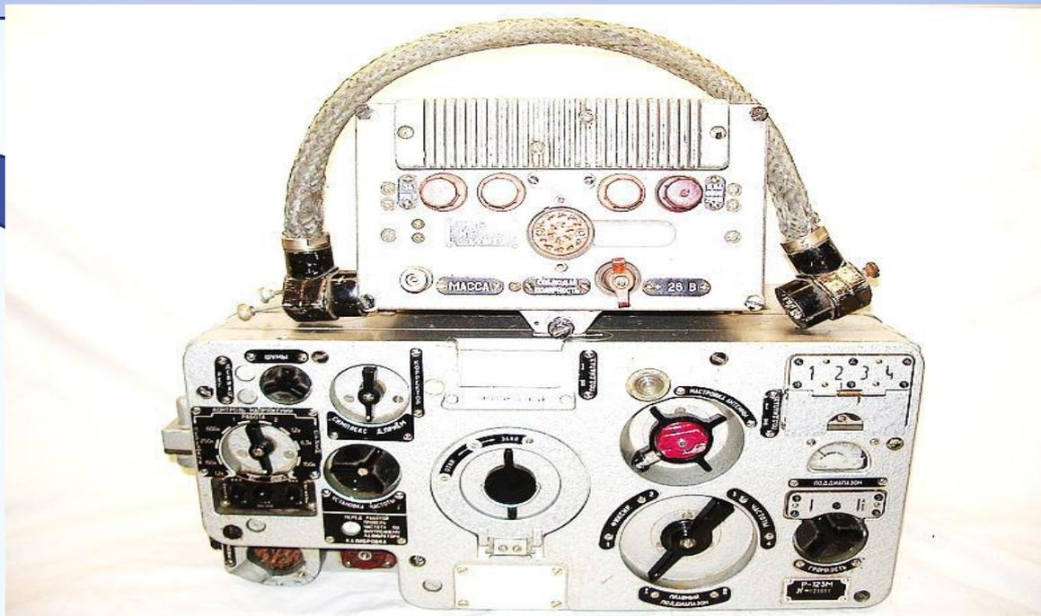
Радиостанция Р-123М предназначена для радиосвязи между подвижными объектами. Р/ст обеспечивает круглосуточную уверенную двухстороннюю связь на стоянке и на ходу объекта как с однотипной радиостанцией, так и с другими р/ст, имеющими совместимость по диапазону и частотную модуляцию, обеспечивает беспереходное вхождение в связь и беспереходное ведение связи.
