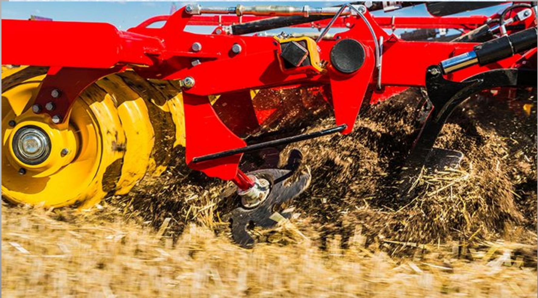
На стояки культиватора Top Down, можуть бути встановлені долота шириною 50, 80 або 120мм. Разом із двома більш широкими розмірами можуть бути встановлені стрілчасті крила шириною 300 мм.
