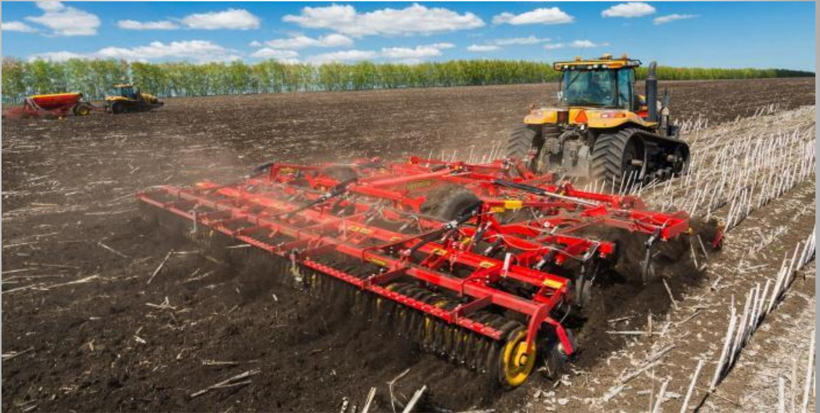
Культиватор TopDown має однакову здатність якісно працювати як під час поверхневого так і глибокого обробітку до 40 см і дозволяє повністю підготувати посівне ложе за один прохід, що забезпечує високу ефективність, економію часу та палива.
