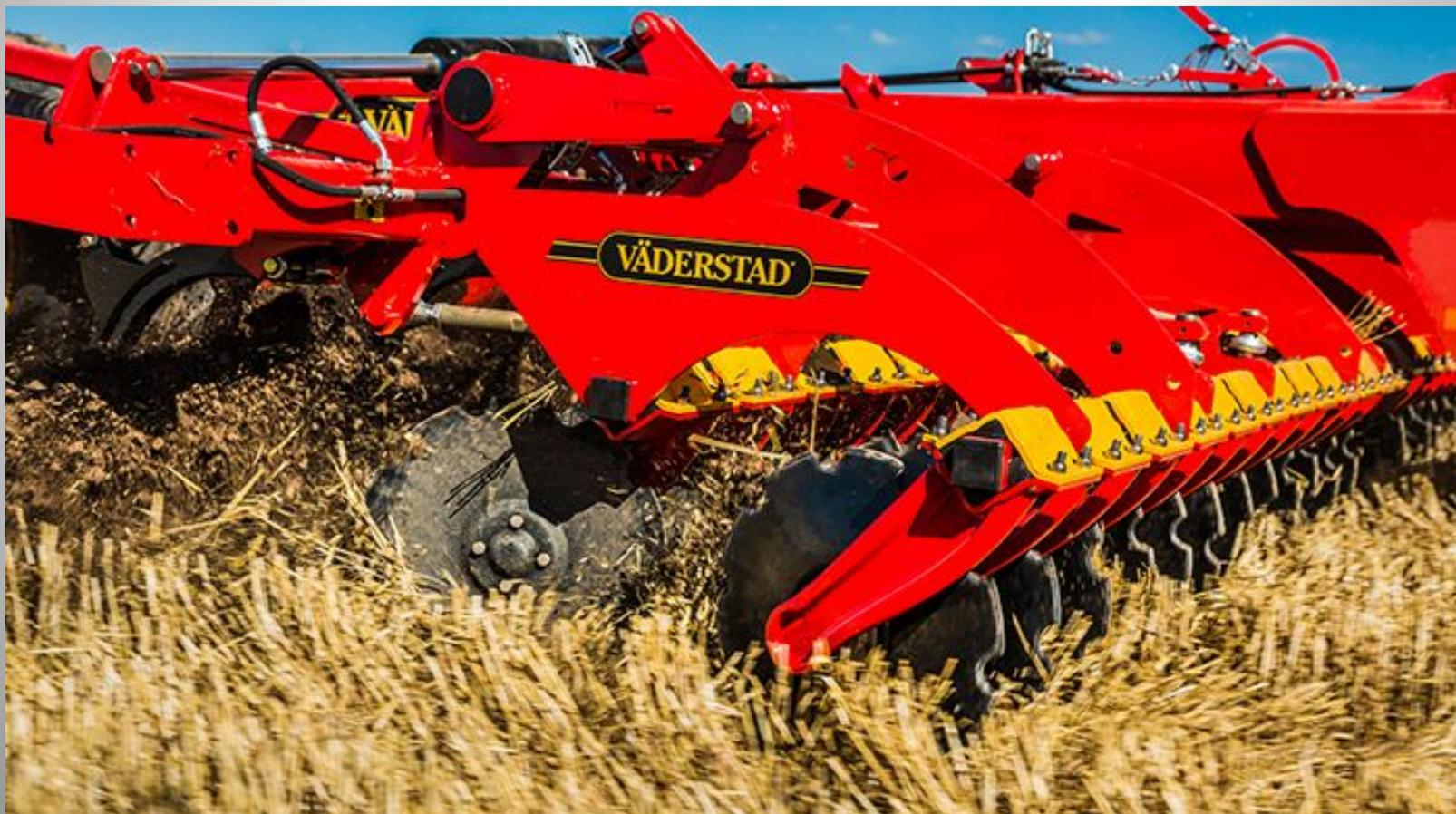
Завдяки невеликій відстані між проходами лап - 27 см досягається якісне перемішування, розпушування та вирівнювання, а кріплення лап в декілька рядів на рамі, яка розміщена на відстані 80 см над поверхнею землі, сприяє хорошій пропускній здатності ґрунтової маси
