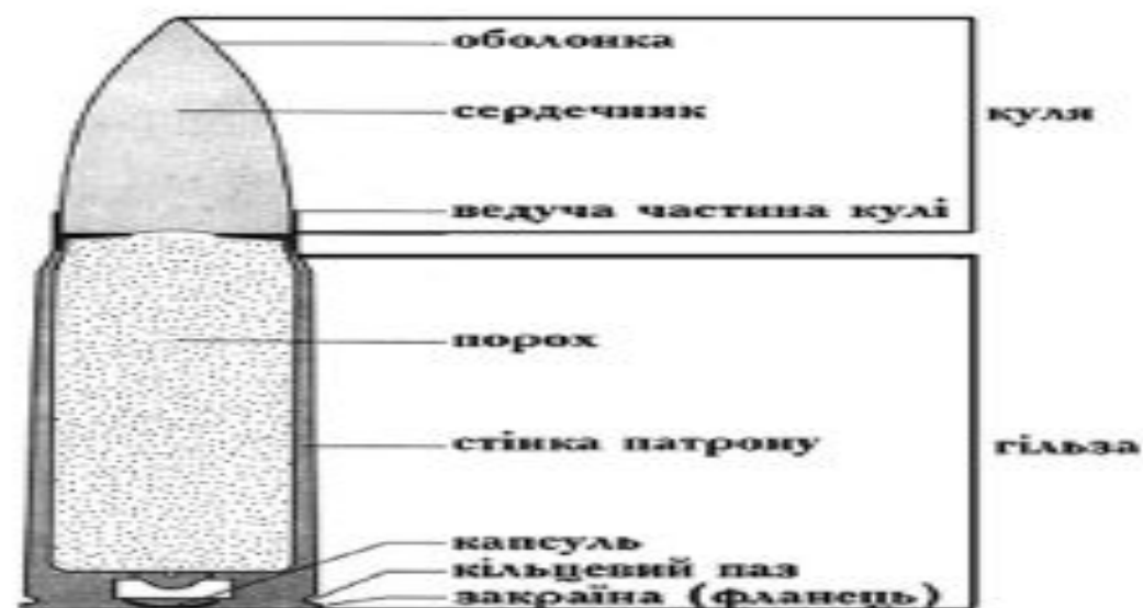
Рис. 13. Устрій патрона центрального запалювання: а — для гладкоствольної зброї; б — для нарізної зброї
