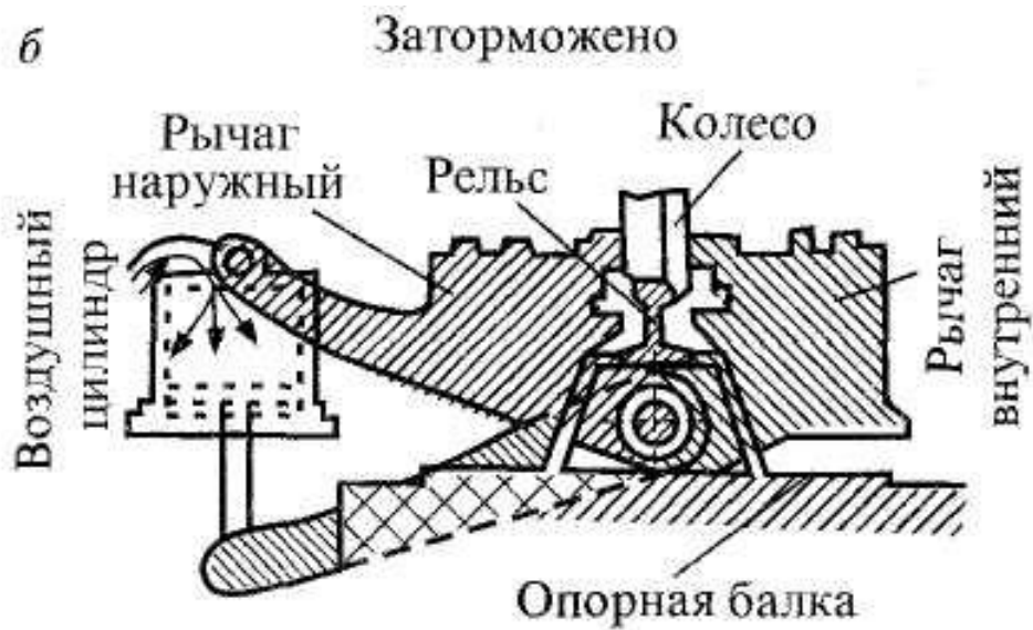
Рис. 5.13. Клещевидный замедлитель
