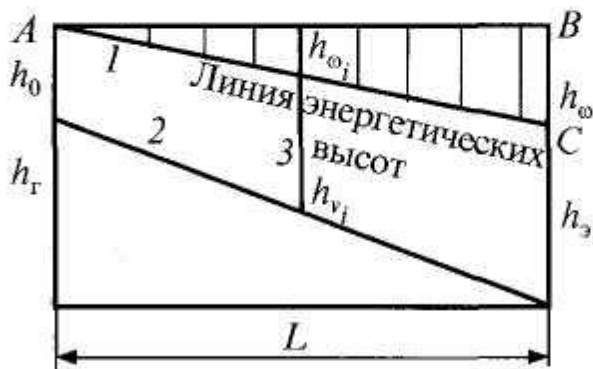
Рис. 5.9. График энергетических высот
