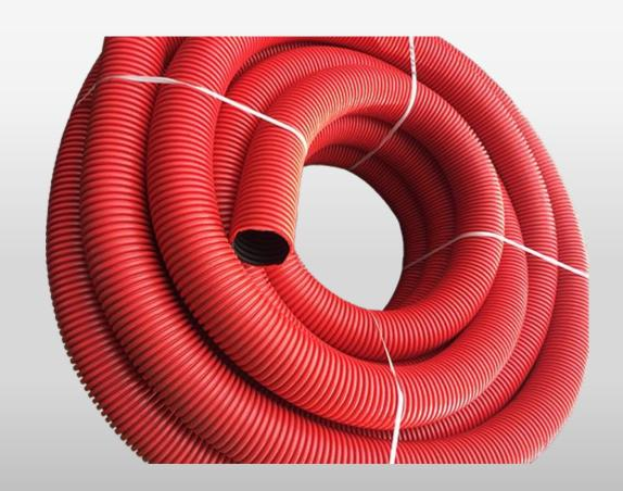
Двустенная труба состоит из наружного гофрированного слоя (ПНД) и внутреннего гладкого (ПВД). Труба обладает небольшим весом и достаточной прочностью для противостояния силовым нагрузкам. Защитные двустенные трубы позволяют максимально просто решить вопросы безопасности, укладки и надежности кабельных линий. Они надежны, доступны по цене и могут быть использованы в самых различных местах: в промышленности, сельском хозяйстве, в помещениях и на открытом воздухе (при t от -40° до +90°.
