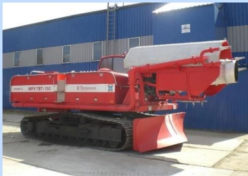
Роботизированная платформа с системой порошкового тушения для разведки и тушения очагов пожаров в труднодоступных местах (тоннелях, метро)
