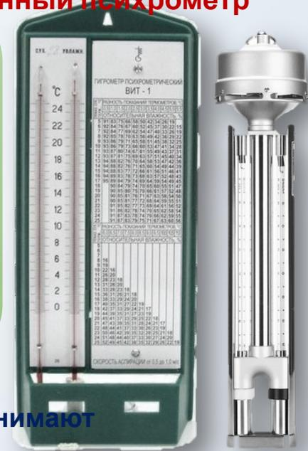
Психрометры подвешиваются на нормируемой высоте от пола. Показания снимают через 15 минут после смачивания ткани «влажного» термометра.
