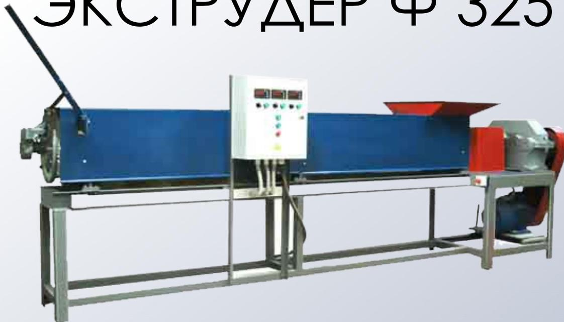
**Экструдер** — это машина для непрерывной переработки полимерного сырья (гранул, дробленки, агломерата) в однородный расплав и придания ему формы путём продавливания через экструзионную головку и специальное калибрующее устройство, сечение которого соответствует конфигурации готового изделия.
