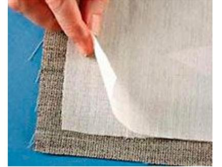
**Прикладные материалы** используются для создания и сохранения объемной формы одежды, предохранения срезов деталей от растяжения, от осыпания нитей, для усиления стойкости изгибов к истиранию.
