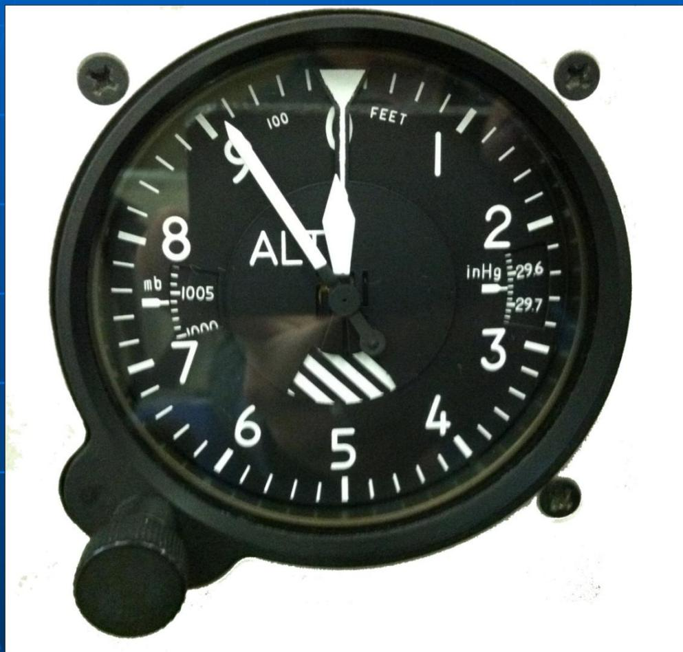
На самолете **P-2002 Sierra** установлен барометрический двухстрелочный высотомер (футомер) United Instruments 5934PM-3
