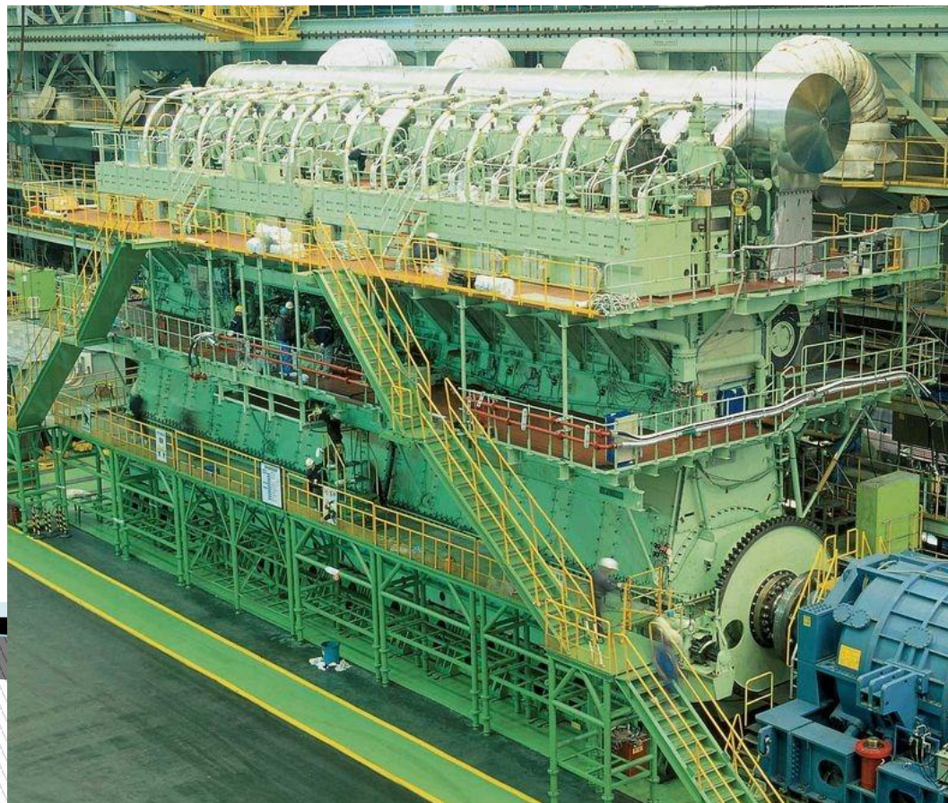
Дизель Wartsila-Sulzer RT – flex96C мощностью 80080 кВт
