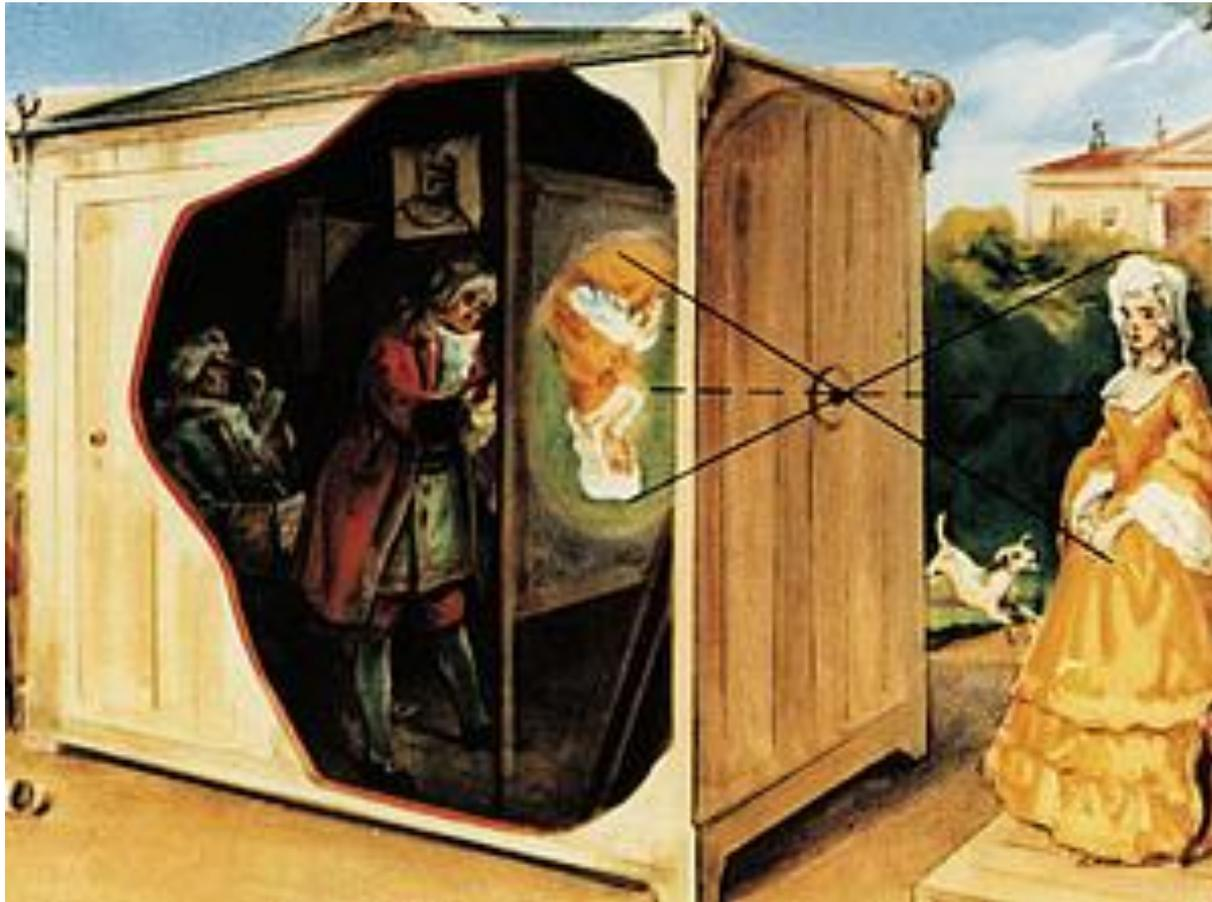
По внешнему виду камера-обскура представляет собой темный ящик с небольшим отверстием в одной из стенок. На противоположной стороне находится так называемый экран, который покрыт либо матовым стеклом, либо же тонким белым листом бумаги. Когда лучи света проходят через отверстие, то на экране получается перевернутый образ внешнего мира.
