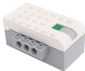
СмартХаб – микрокомпьютер WeDo 2.0
