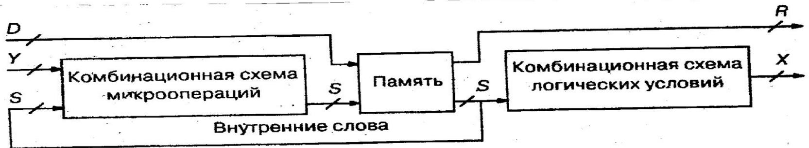
Рис. 15.1.2. Структура операционного автомата
