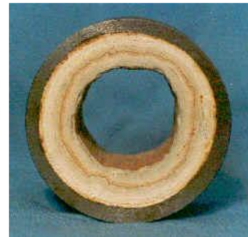
отложение солей на рабочем колесе ЭЦН и в НКТ
