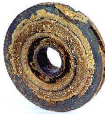
отложение солей на рабочем колесе ЭЦН и в НКТ
