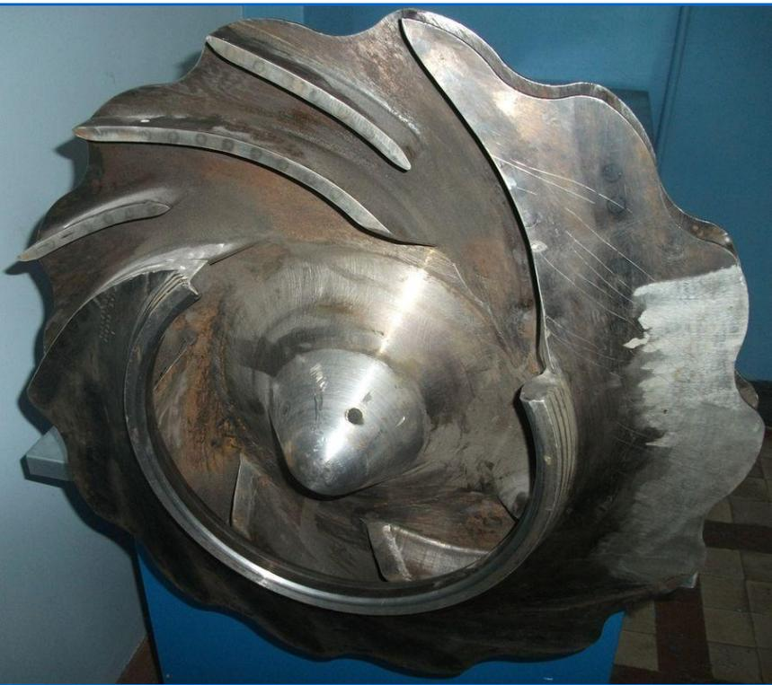
Рабочее колесо центробежного нагнетателя представляет собой сложное тело вращения (диск), на котором установлены лопатки, расходящиеся от центра к краям диска. Межлопаточный канал в центробежном рабочем колесе - расширяющийся (диффузорный). В центробежном нагнетателе поток газа входит в рабочее колесо вдоль оси вращения ротора, а в рабочем колесе происходит поворот потока в радиальном направлении.
