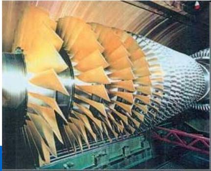
Компрессор (от лат. compressio — сжатие) — устройство для сжатия и подачи газов под давлением.
