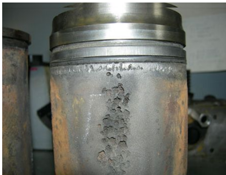
Кавитационные повреждения гильзы цилиндра поршневого ДВС
