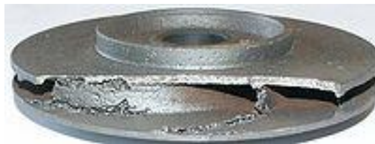
Кавитационные повреждения рабочих колес гидронасосов
