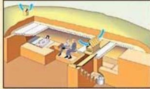
Быстровозводимое противорадиационное укрытие из железобетонных плит
