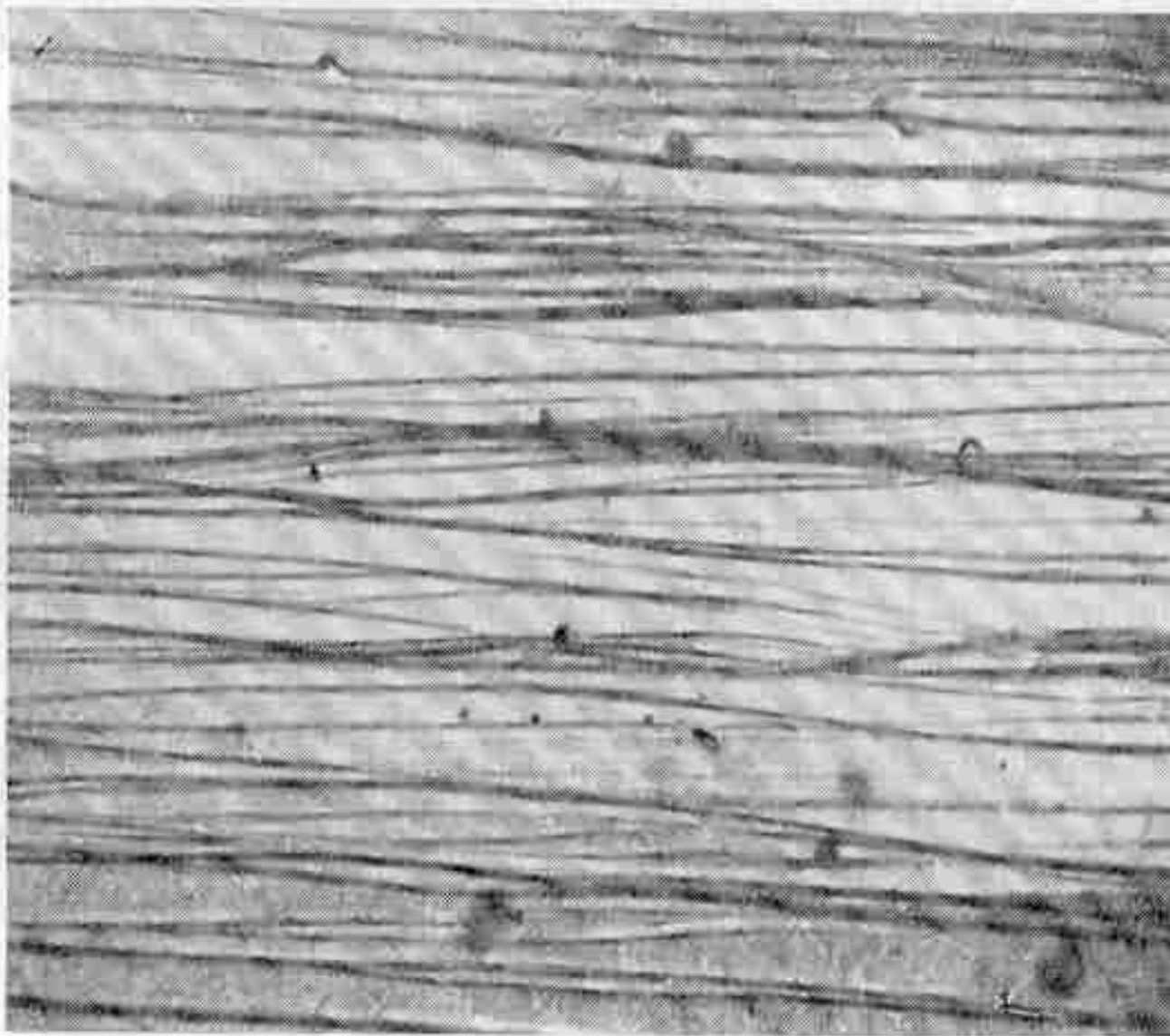
Рис. 3.6. Линии скольжения на грани (110) кристалла железа с 3% кремния, деформированного при комнатной температуре (X 31 100)
