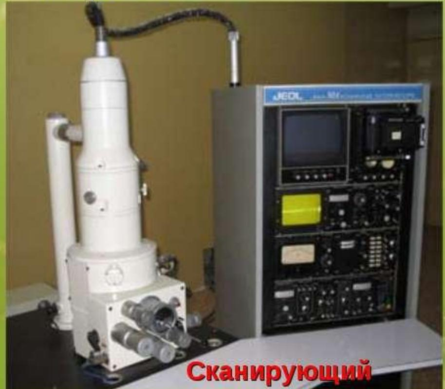
**Сканирующий электронный микроскоп.**
