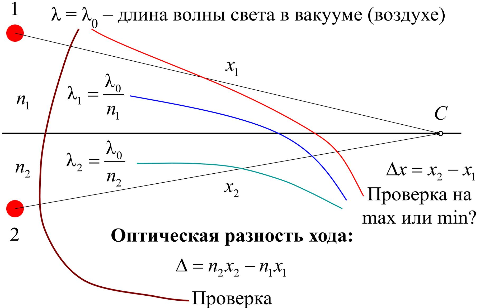
*При отражении света от оптически более плотной среды* (с большим показателем преломления) происходит смена фазы волны на противоположную, что учитывается добавкой в  $\Delta$  слагаемого
