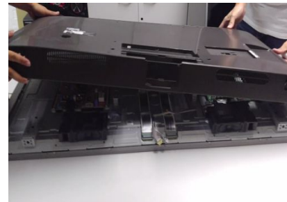
7. Собрать переднюю и заднюю части
