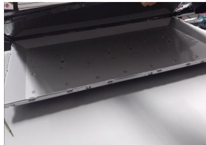
6. Оставить только заднюю подсветку и ЖК панель.
