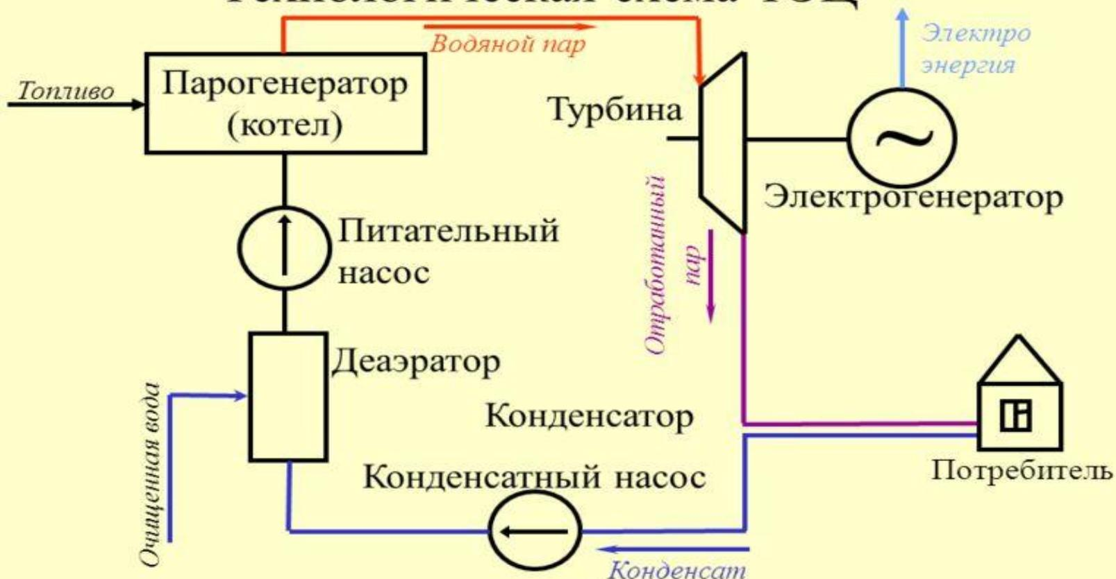
Очевидно, что оборудование ТЭЦ отлично от оборудования КЭС лишь в той его части, что связана с отбором пара и горячей воды из контура и передачей их для снабжения внешних потребителей.
